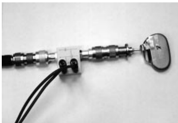
Anschluß des Herzschrittmachers für GSM- und TV-Messung
