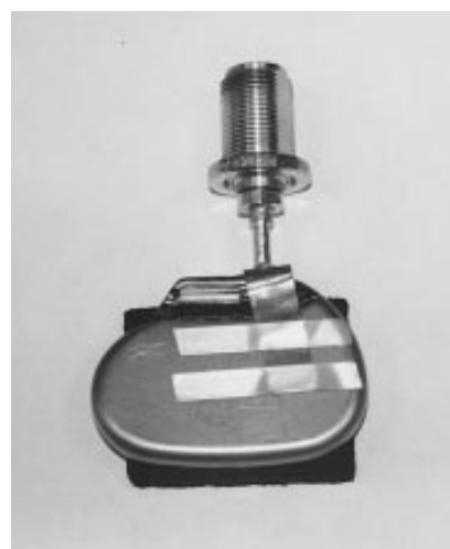
Anschluß des Herzschrittmachers für Impedanz, GSM- und TV-Messung
