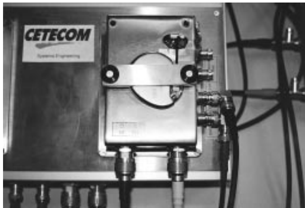
Anschluß des Herzschrittmachers für Messungen nach EN 50061
