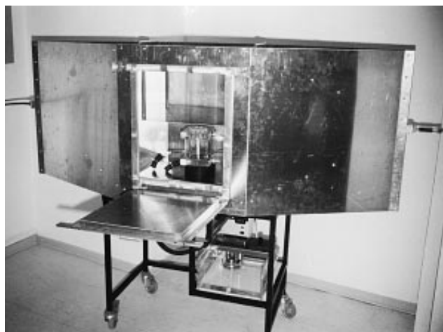
Abbildung 6: TEM-Zelle mit Einblick in den Innenraum. Im unteren Zellenmitteteil befindet sich der Probenhalter mit neun Kulturröhrchen. Darüber ist das isolierte aufgehängte Septum erkennbar, das die Funktion des Innenleiters übernimmt. Außerhalb der TEM-Zelle befindet sich das Temperierbad.
