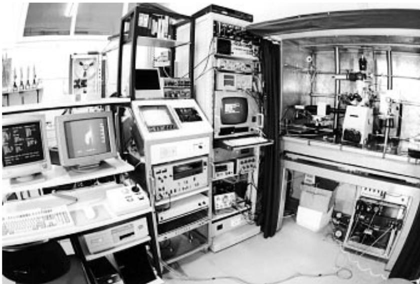
Abbildung 7: Übersichtfoto des Versuchsaufbaus mit seinen unterschiedlichen Komponenten (von links nach rechts): Bildverarbeitungsrechner, „rack“ mit Videoausrüstung und „online“-Bildverarbeitung, daneben „rack“ mit Geräten zur Steuerung des Standes und schwingungsgedämpfter Tisch mit inversem Mikroskop.
