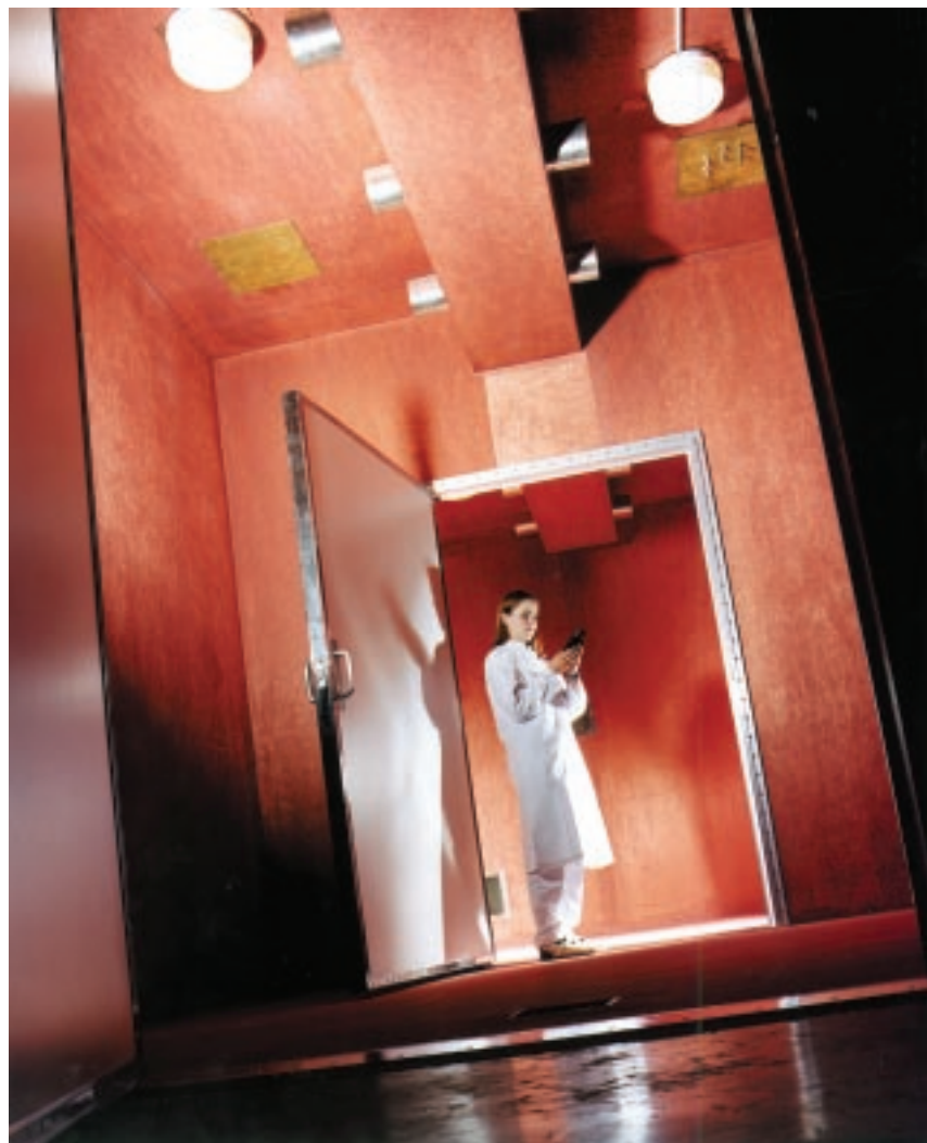
Embryotoxizitätsstudie: Exposition von trächtigen Ratten gegenüber einem gepulsten HF EMF (900 MHz, 217 Hz pulse) mit 4.6 \text{ W/m}^2 (menschlicher Grenzwert) in speziell abgeschirmten Tierräumen erbrachte keine teratogenen embryolealen entwicklungsretardierenden Effekte.
