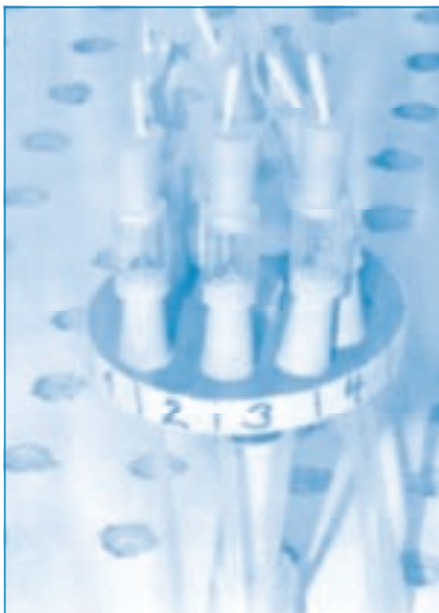
Abb. 18: Versuchskammern zur direkten Exposition von Pinealorganen durch schwache Magnetfelder. In jede Kammer werden Pinealorgane erwachsener Dsungarischer Hamster eingesetzt und mit Puffer überspült (perifundiert). Im Eluat wird anschließend Melatonin bestimmt. Zur Produktion von Melatonin ist es nötig, die Organe pharmakologisch zu stimulieren. Aus [137].
