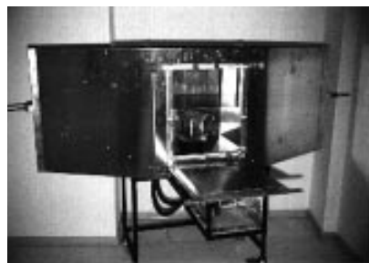
Abbildung 6: Die in Berlin und Essen eingesetzte TEM-Zelle mit Einblick in den Innenraum. Der Probenhalter mit den Zellkulturröhrchen befindet sich im unteren Mittelteil der Zelle. Darüber erkennt man das isoliert aufgehängte Septum, das die Funktion des Innenleiters hat. Das Temperaturbad befindet sich rechts unterhalb der TEM-Zelle.
